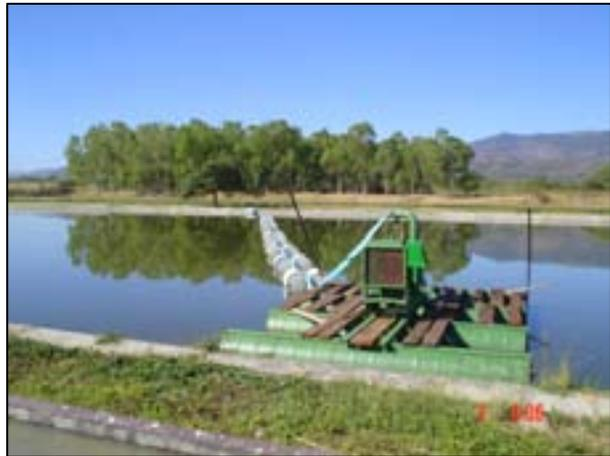
**Figuras 13 –Manguera de impulsión sobre el agua**
