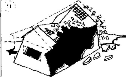
11. Si el terremoto se mueve paralelo a aquellos muros que no son de carga, el daño será mayor y los muros longitudinales pueden caerse a lo largo de toda la casa y arrastrar los transversales.
