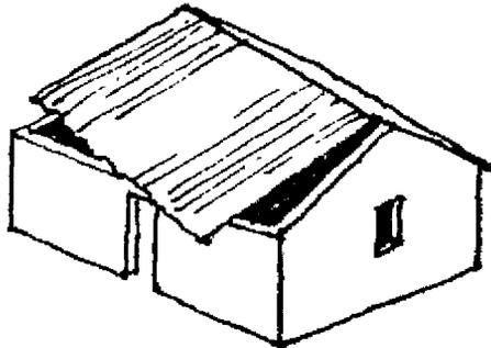
7. DESLIZAMIENTO DE TODA LA ESTRUCTURA
