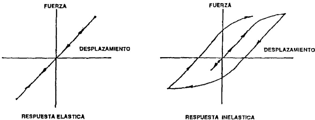
Figura 2 Respuesta de Sistemas Elásticos e Inelásticos
