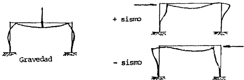
Figura 8 Superposición de Efectos: Gravedad + Sismo
