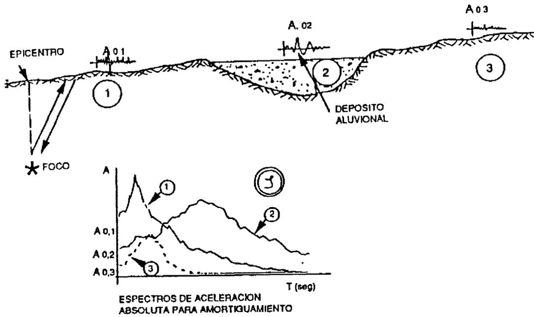
FIGURA 5 CAMBIOS ESPERADOS EN LOS MOVIMIENTOS DEL TERRENO, COMO CONSECUENCIA DE UN EVENTO SISMICO DE FOCO SUPERFICIAL
