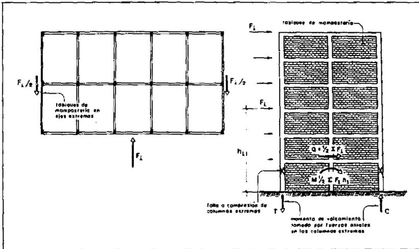
**Fig. 13 - Paredes de mampostería debido a su rigidez, transforman los pórticos extremos en virtuales muros de corte, que atraen las fuerzas laterales. Cargas axiales debido a momento de volcamiento pueden causar la falla de las columnas.**
