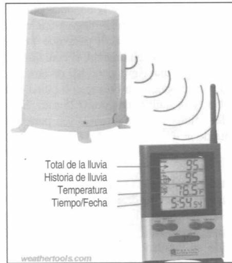
**Fig. 6.6 Fotografía del pluviógrafo RGR-122**
