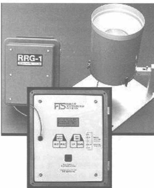
**Fig. 6.5 Pluviógrafo RRG-1**
