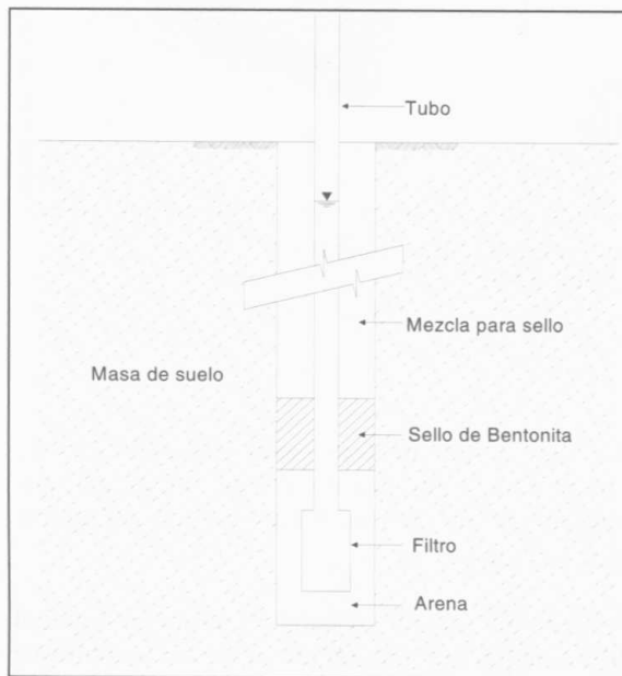
Fig. 6.17 Esquema de un piezómetro de tubo abierto tipo Casagrande, (Dunnicliff, 1993)
