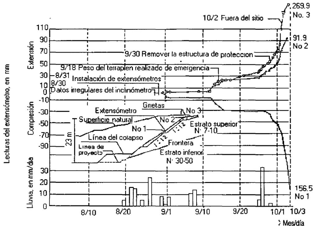
**Fig. 8.4 Evolución de las lecturas de extensómetros y pluviómetros**
