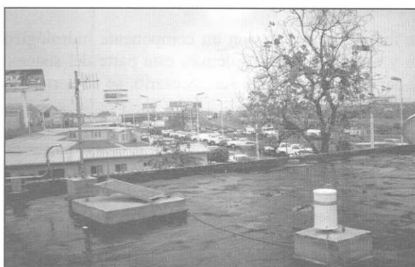
Figura 7.8 Pluviómetro, celda solar y antena, estación Fierro, FE-04
