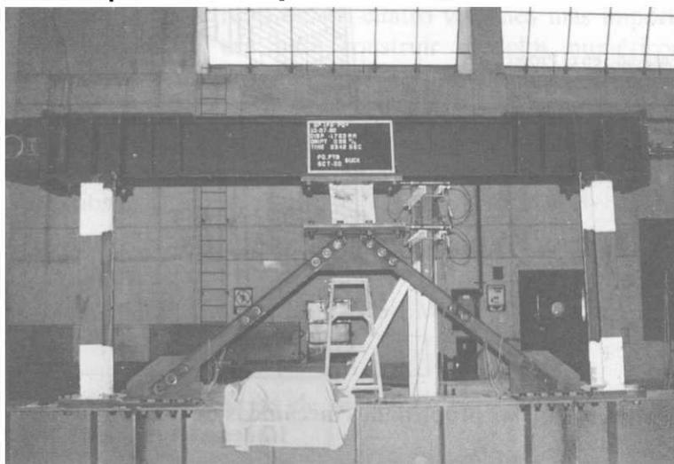
Ensaye de Dispositivo para Disipación de Energía Sísmica
