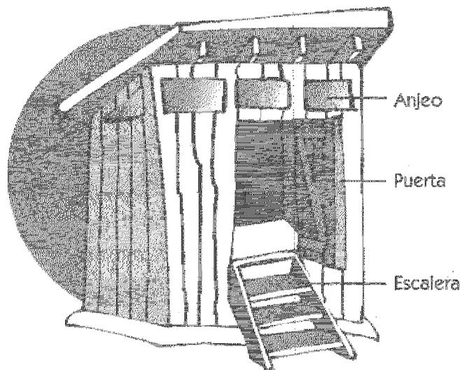
Es una alternativa de saneamiento que consta de una doble cámara impermeable y un sentadero especial que separa las heces de la orina. A las heces depositadas en la cámara se les agrega ceniza, cal o tierra seca, para favorecer el proceso de degradación biológica en seco. Cuando una letrina abonera seca familiar (LASF) ha sido adecuadamente usada se puede obtener un abono orgánico relativamente inocuo.
