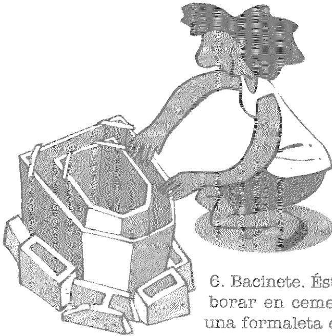
6. Bacinete. Éste se puede elaborar en cemento utilizando una formaleta de madera.
