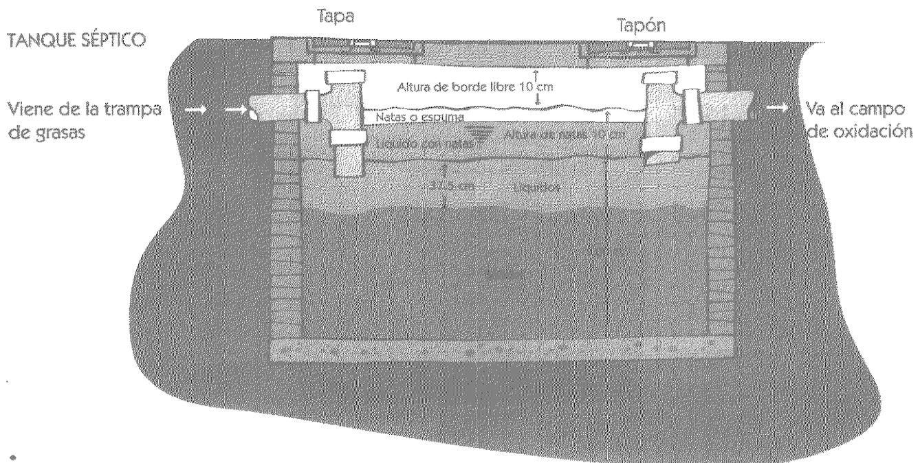
El líquido que sale del tanque séptico tiene altas concentraciones de materia orgánica y organismos patógenos por lo que se recomienda no descargar dicho líquido directamente a drenajes superficiales sino conducirlo al campo de oxidación para tratamiento.
