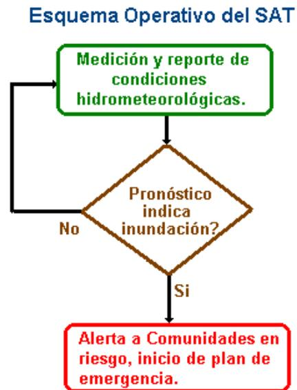
Figura 9.1 Esquema de un Sistema de Alerta Temprana para inundaciones.
