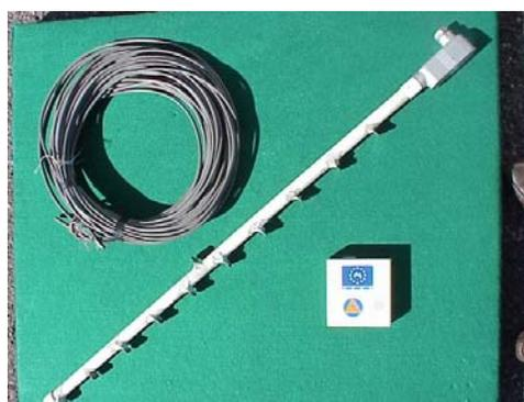
Foto # 11 : unidad de medici n de nivel de r o. Se muestran el cable, el sensor y la unidad de
