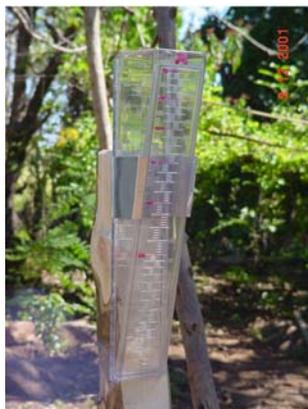
Foto # 12: pluvi metro instalado En El Corozo.
