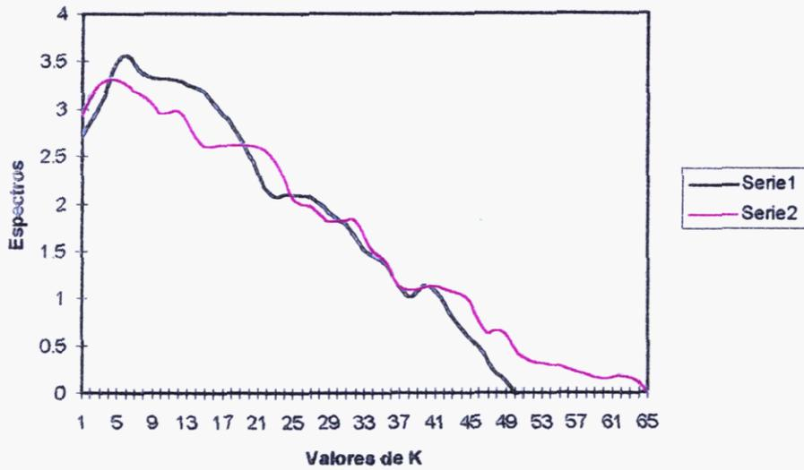
**Fig.1.5.7:** Gráficos de la función espectral ( $\text{cm h}^{-1}$ ) de la componente no periódica del nivel del mar en el dominio de las frecuencias medias en la estación de Manzanillo (1993) - serie 1 y (1994) - serie 2, calculada con un corrimiento máximo de la función de correlación igual a 800.
