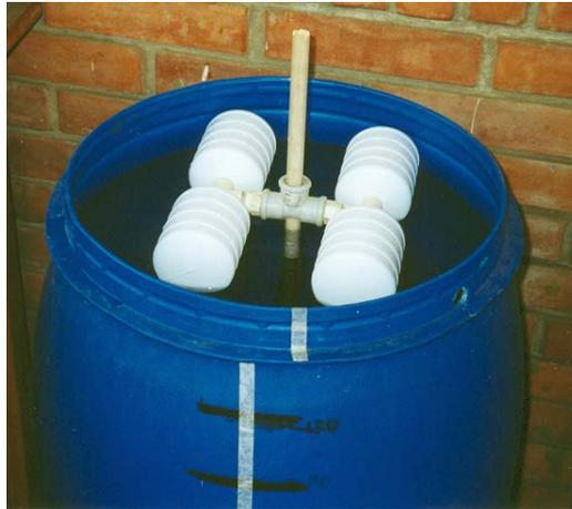
La preparación manual de la solución de hipoclorito se tiene que hacer con mucho cuidado, como se explicó anteriormente. Cuando se usa hipoclorito de calcio, la concentración de la solución debe ser entre 1% y 3% de cloro disponible para impedir la formación excesiva de depósitos y sedimentos de calcio. Las soluciones de hipoclorito de sodio pueden ser hasta de 10%. Las concentraciones mayores no son aconsejables porque pierden potencia rápidamente y si son muy altas se pueden cristalizar.
