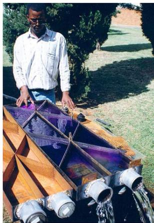
Conducto sobre el que se colocarán las lámparas UV para desinfección del agua. El diseño de las pantallas dentro del conducto sirve para asegurar que el flujo de agua a ser desinfectada se deslizará con un frente homogéneo y asegurará que toda el agua tenga igual irradiación.
