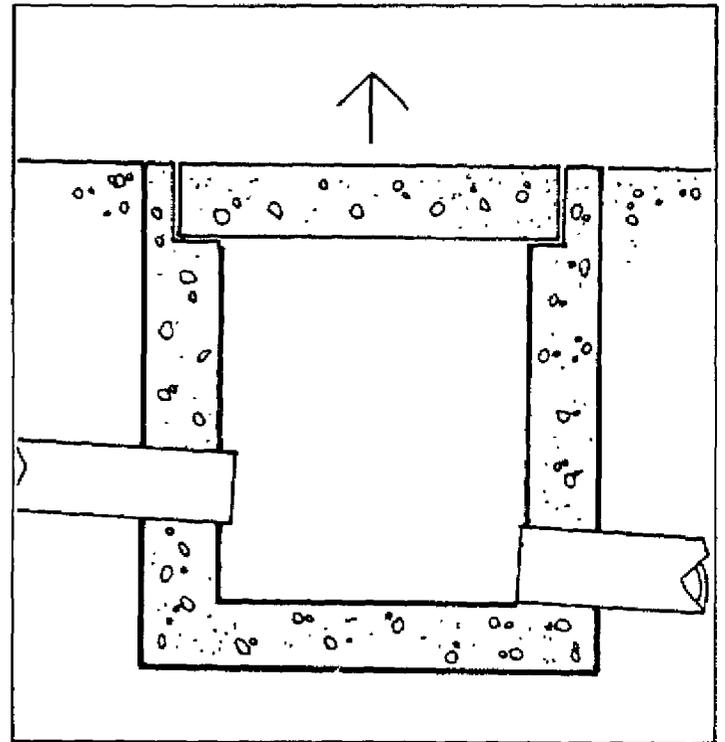
CORTE TÍPICO DE UNA TANQUILLA. LAS TAPAS PUEDEN SER METÁLICAS O DE CONTACTO. PARA DESTAPAR ES NECESARIO RECURRIR A UNA BARRA DE HIERRO
