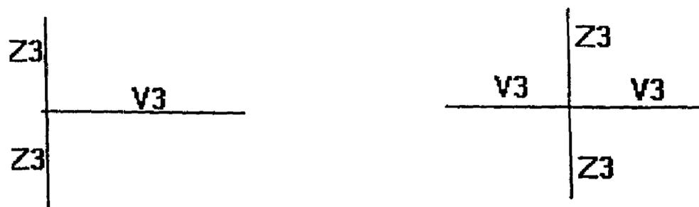
Figura 6.11 Nudos típicos para 3ro, 2do, 1o y planta baja. Eje 6.
