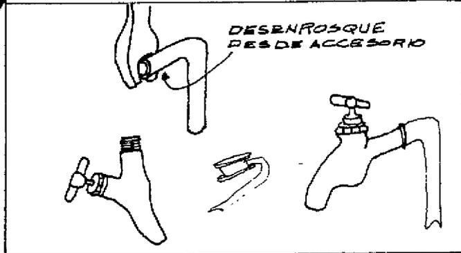
Empaque gastado -DESENROSCAR parte superior del chorro o válvula -NO la manecilla -LIMPIE costra en las roscas QUITAR tornillo que sujeta el empaque PONER el nuevo -PONER cinta teflón en rosca de chorro o válvula.
