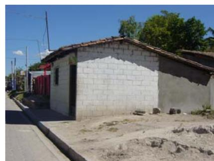
**8. Previsión de las ampliaciones:** el prever una ampliación a futuro disminuye costos y sobre todo la vulnerabilidad; si se construyen edificios que puedan ser ampliados, hay que pensar en un sistema que permita que la construcción nueva y la antigua queden unidas monolíticamente.
