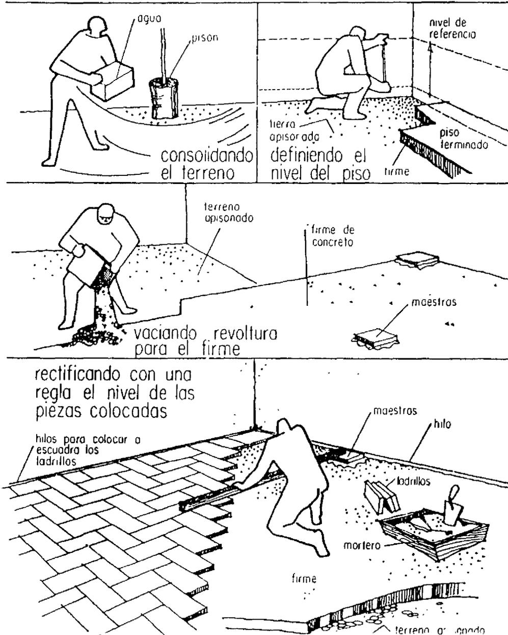
Una vez definido el nivel del piso, se consolida el terreno apisonado y regando la tierra, encima de ésta se tiende un firme de concreto en proporción 1:4:8. Sobre él se colocan maestras que sirven para llevar el nivel del piso.
