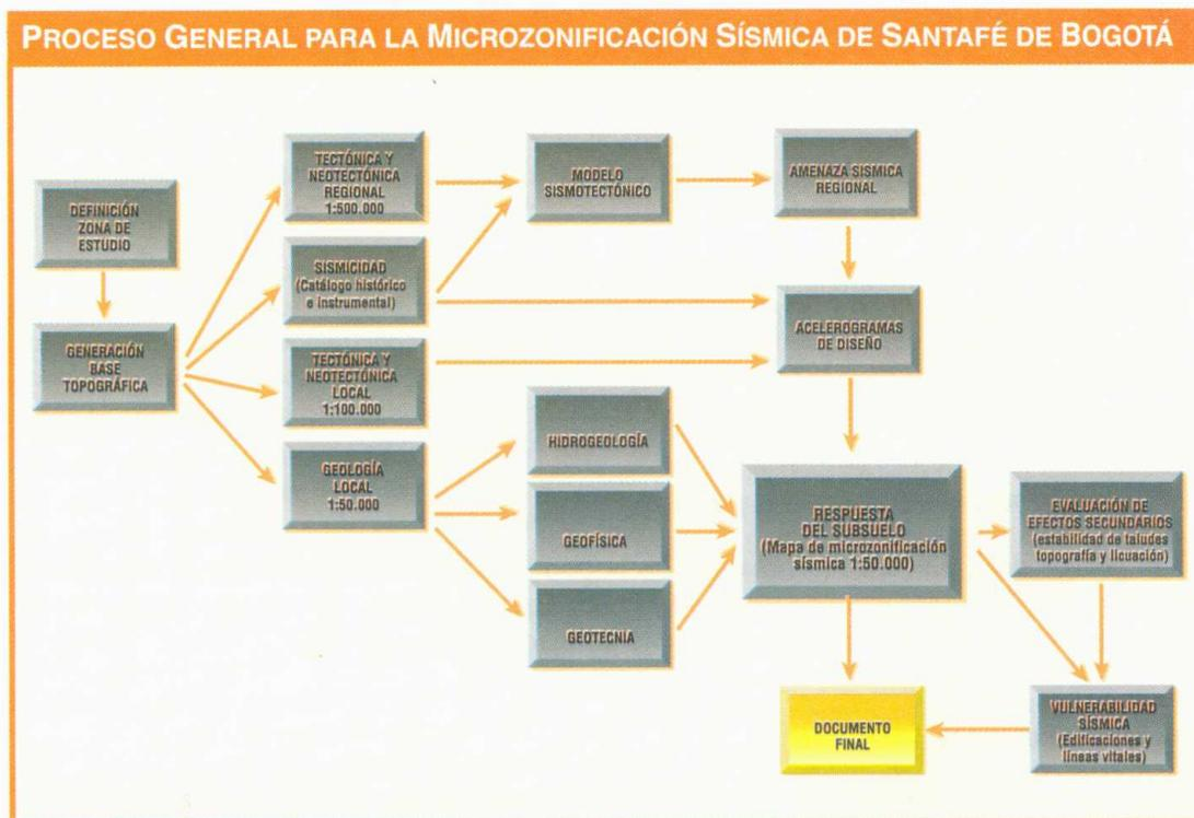
FIGURA I.2 PROCESO GENERAL PARA MICROZONIFICACIÓN SÍSMICA DE SANTAFÉ DE BOGOTÁ
