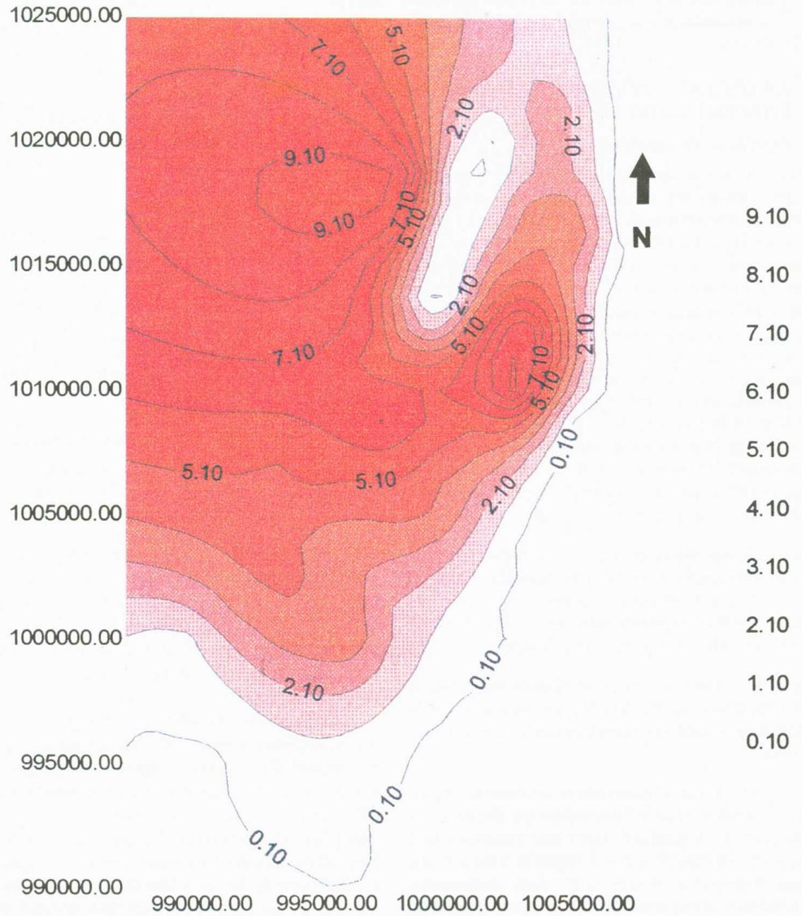
FIGURA 3.10 MAPA DE ISOPERIODOS FUNDAMENTALES DEL DEPÓSITO
