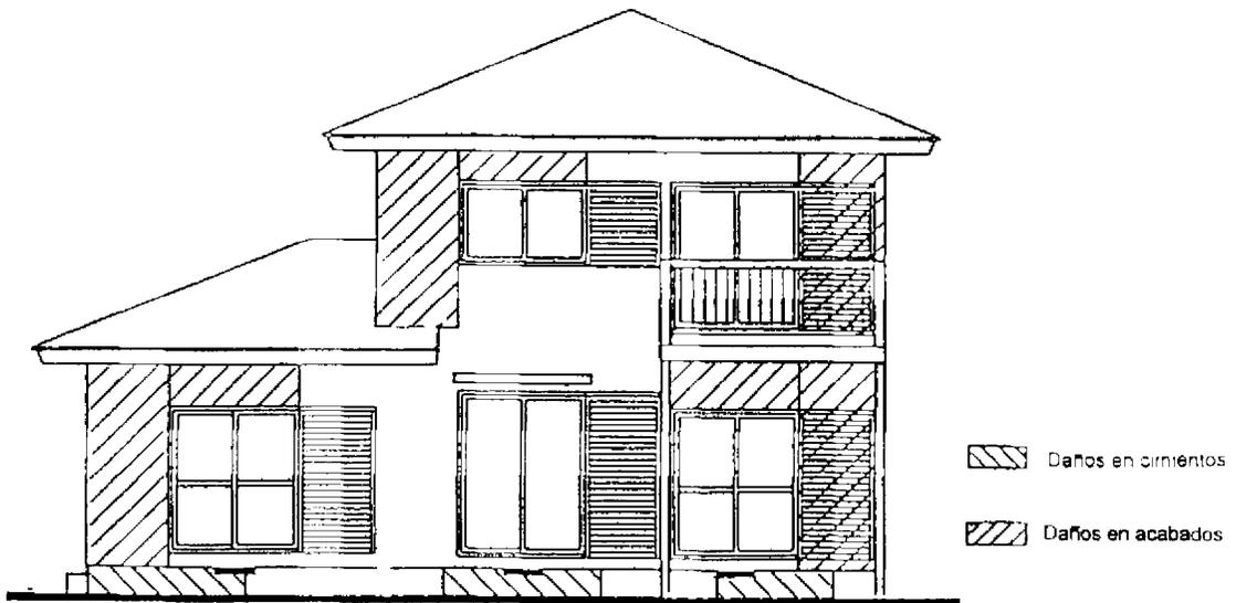
**Figura 6. Distribución de Elementos Dañados en la Elevación Sur**
