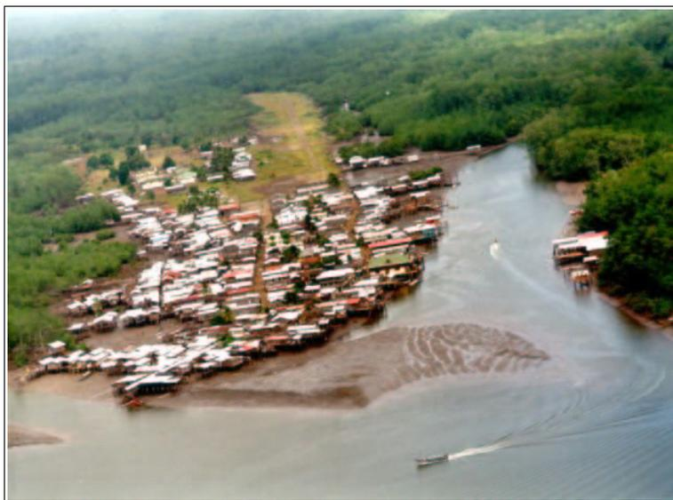
El acceso principal es marítimo y la infraestructura vial y de transporte está conformada por vías amplias sin pavimentar asentadas sobre terrenos que han sido rellenados con material del sitio (en su mayoría arcillas y turbas), un muelle principal y una pista de aterrizaje (en reparación) de aproximadamente 500 m de longitud en pavimento flexible.
