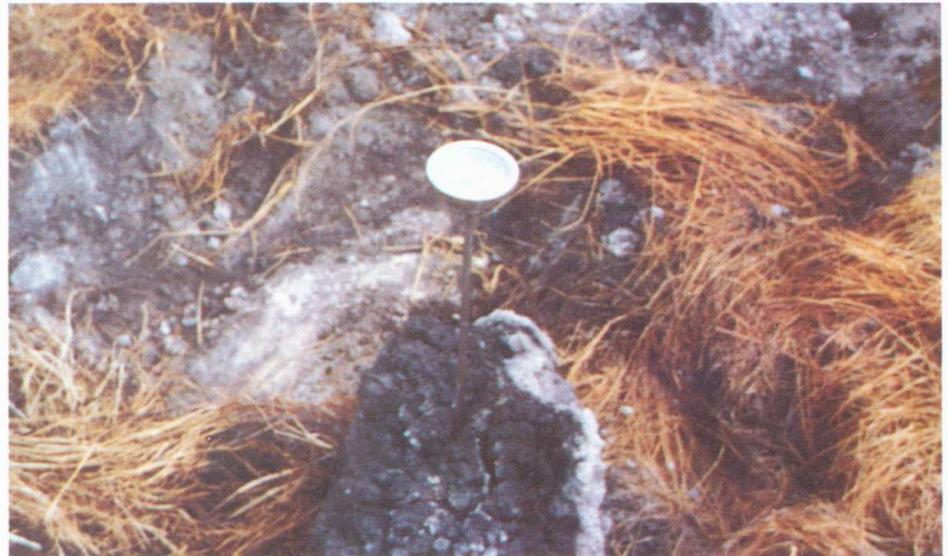
Medición de la temperatura en el sitio mediante un termopar en un trozo de carbón removido
