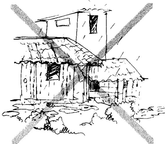
Cuando no hay canales, el agua va rodando por las zanjas profundas, hechas por el hombre y deterioran el terreno de laderas. El terreno se desestabiliza y puede deslizarse.
