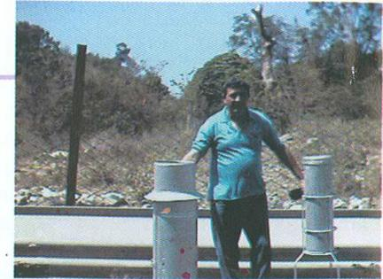
Pluviógrafo y pluviómetro al fondo de la foto, donde se registran las lluvias caídas. Se encuentran ubicado en Calentura (Chivirico).
