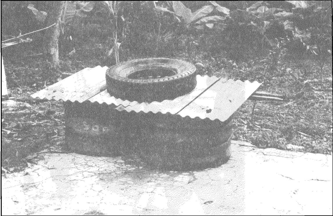
**Foto 3.** Protección para los dos sismómetros instalados en Saucedo.
