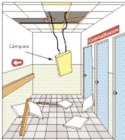
En zonas expuestas a sismos, para evitar la caída de equipos que se encuentran asegurados al cielo falso, se sugiere colocar soportes independientes, fijados directamente a elementos de la estructura principal de la cubierta, que son fuertes y rígidos para que puedan resistir la carga.
