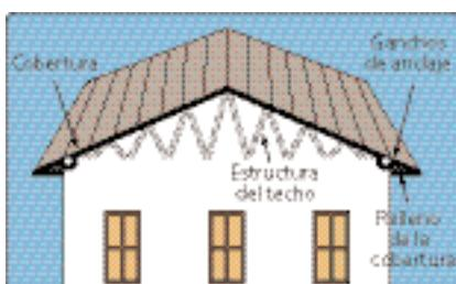
Especialmente en zonas expuestas a vientos fuertes, a fin de evitar el ingreso de corrientes de aire que puedan levantar la cobertura y destruir el techo, se recomienda cerrar las aberturas existentes bajo las coberturas y techos, con mampostería, muro o material elastomérico. Esta medida se
