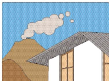
Es necesario revisar el estado y la resistencia de la estructura del techo y los elementos del recubrimiento, a fin de soportar el peso extra que pueda recibir en una caída de cenizas.
