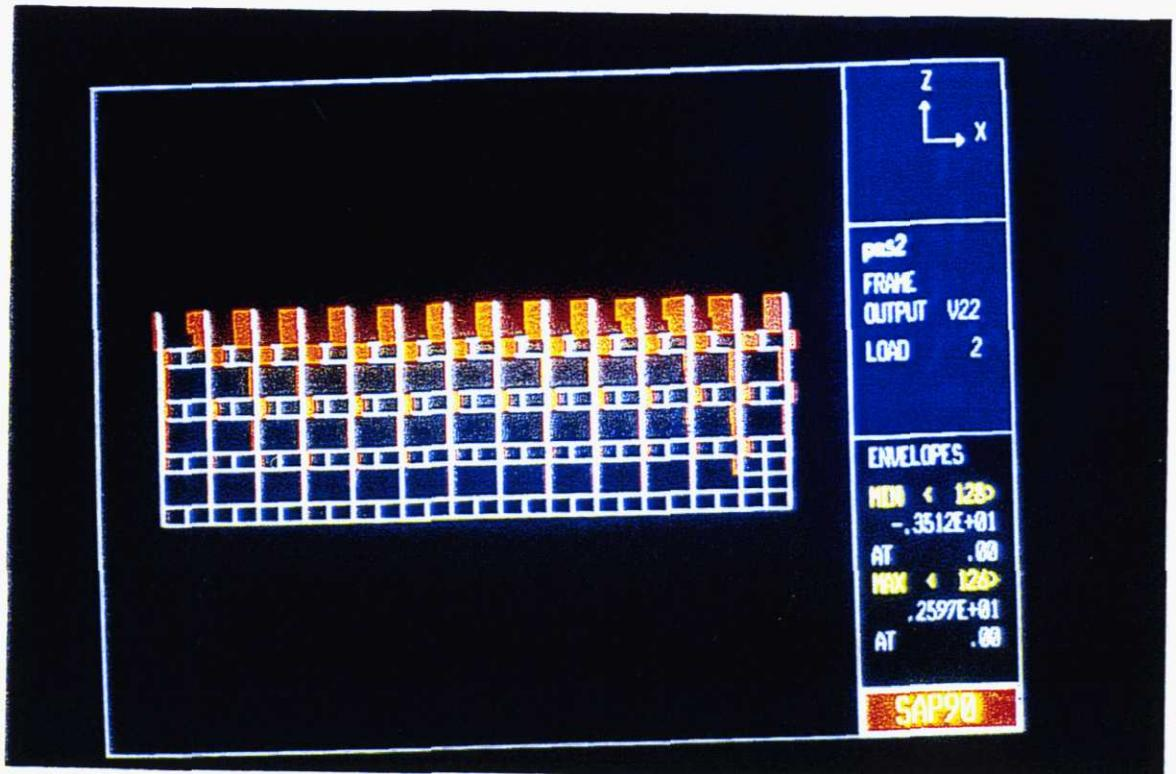
ESFUERZOS EN COLUMNAS DE FACHADA ESTE EXISTENTE
