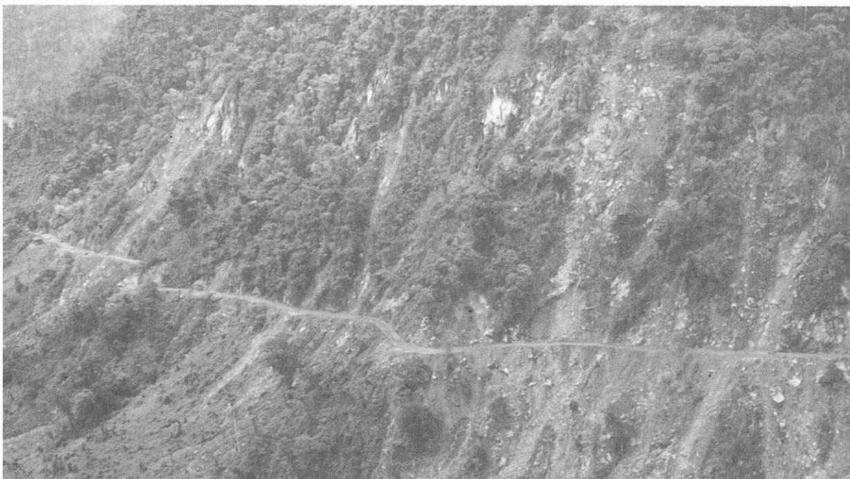
**FIGURA 5.5** Deslizamientos a lo largo de la carretera trans-ecuatorial 3 km al O de su cruce con el río Salado. Estas caídas de rocas, deslizamientos y avalanchas, que fueron generados por los sismos del 5 de Marzo de 1987, bloquearon la carretera de manera casi continua como se muestra en esta fotografía. Esta carretera fue nuevamente útil el 25 de Abril de 1987 debido a los esfuerzos del Cuerpo de Ingenieros (Ejército Ecuatoriano) con sus equipos de mantenimiento de carreteras.
