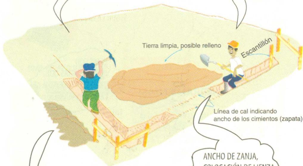
Línea de cal indicando ancho de los cimientos (zapata)
