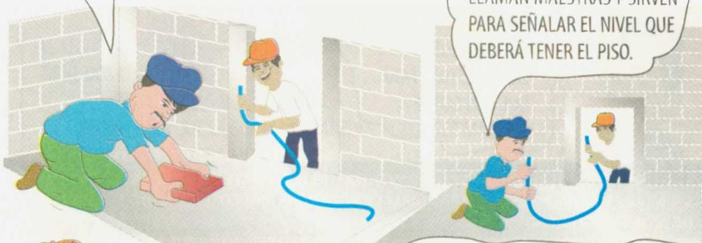
EL NIVEL DE TODAS LAS MAESTRAS DEBE QUEDAR A LA ALTURA DE LA VIGA ASÍMICA, PARA ESO UTILIZAMOS LA MANGUERA DE NIVEL.
