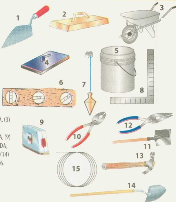
(1) CUCHARA DE ALBAÑIL, (2) LLANA DE MADERA, (3) CARRETILLA, (4) LLANA METÁLICA, (5) CUBO DE PLÁSTICO (6) NIVEL, (7) PLOMADA, (8) ESCUADRA, (9) CINTA MÉTRICA, (10) ALICATE (11) PALA CUADRADA, (12) PINZA DE CORTE DIAGONAL, (13) MARTILLO, (14) PALA OVALADA, (15) ALAMBRE DE AMARRÉ n.º 16.
