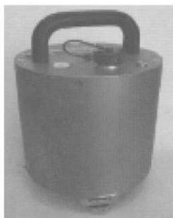
**Figura 2.3 Sismómetro triaxial (CMG-40T)**
