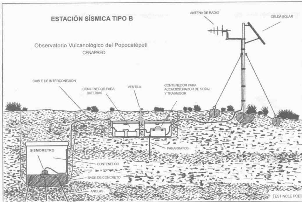
**Figura 3.8 Estación sísmica tipo B**
