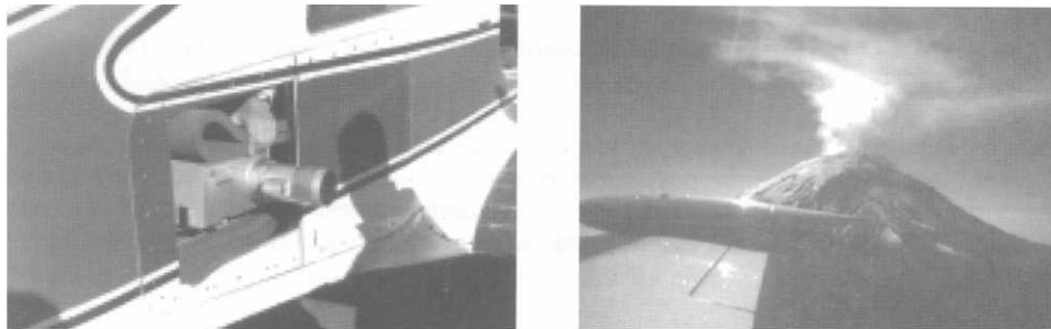
Figura 3.21 y 3.22 Montaje del COSPEC sobre una aeronave para medición del flujo de SO 2 y vuelo realizado al Popocatepetl para medición del flujo de SO 2
