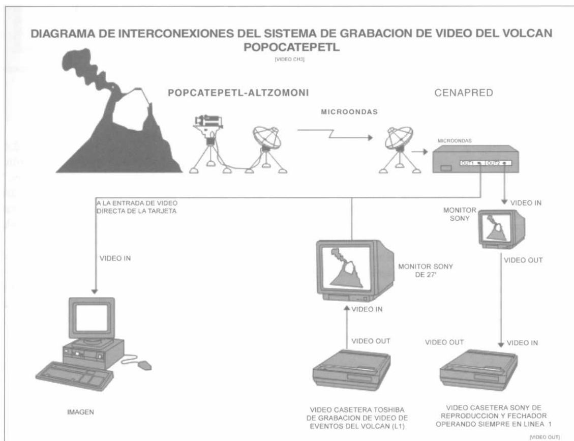
Figura 4.6 Esquema para la captura de imágenes del volcán
