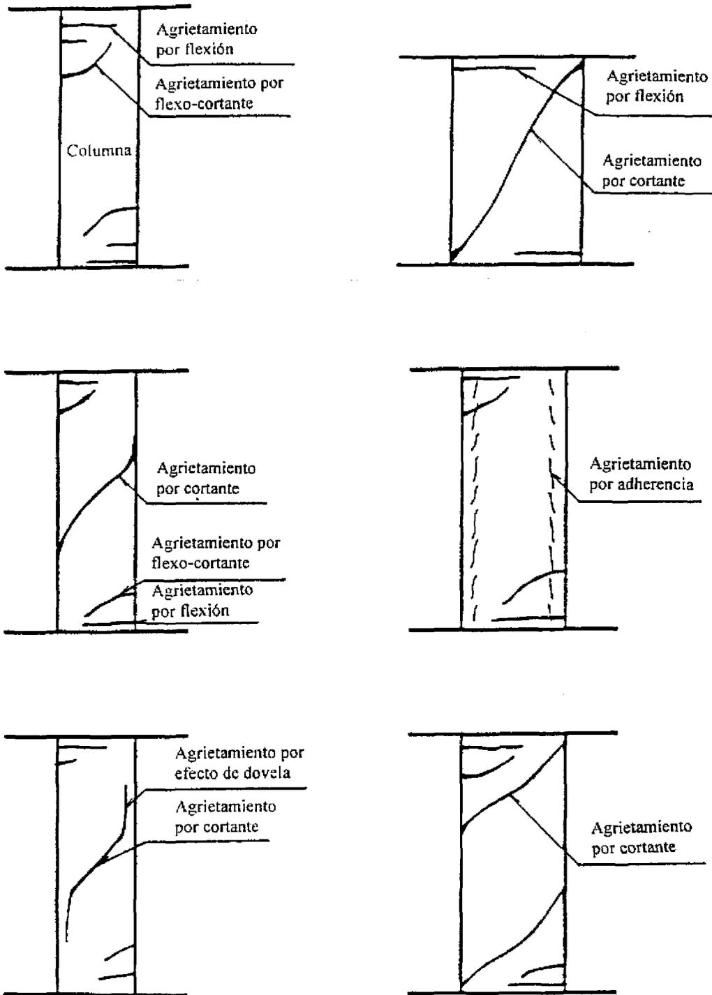
**Figura A.6 Patrón de agrietamiento**
