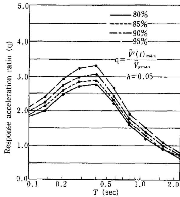
**Figura Apéndice I.2.4.1 Espectro de aceleraciones relativas obtenido a partir de sensores artificiales**
