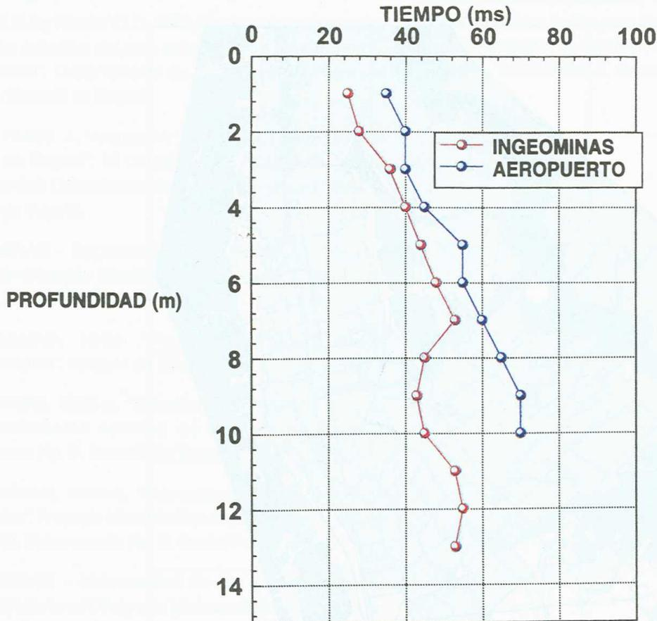
FIGURA 2.26 RESULTADOS DE LOS ENSAYOS DOWN HOLE
