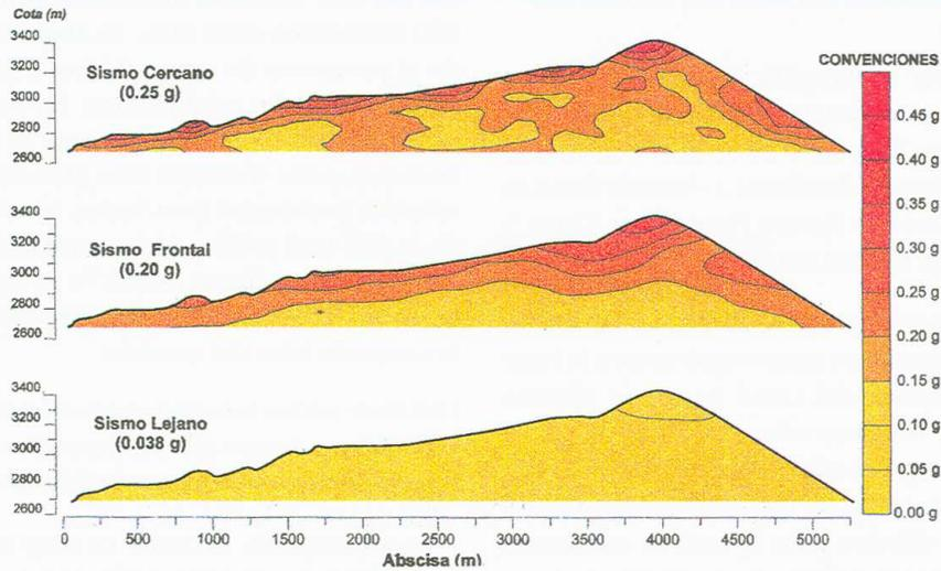
FIGURA 3.17 CORTE No. 3 QUEBRADA BOLONIA MAPAS DE ISOACELERACIONES MÁXIMAS PARA SISMOS DE DISEÑO
