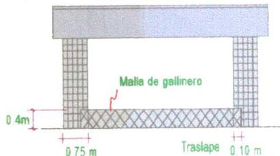
Finalmente se realiza el tarrajeo con una capa de mortero de 2 cm. de espesor y que está compuesto por una proporción de 1 de cemento por 5 de arena.
