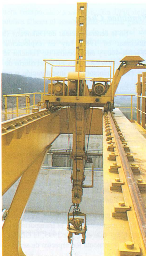
Esta grúa se utilizará en Kozloduy para manipular bidones con un contenido de 200 litros de desechos radiactivos.
