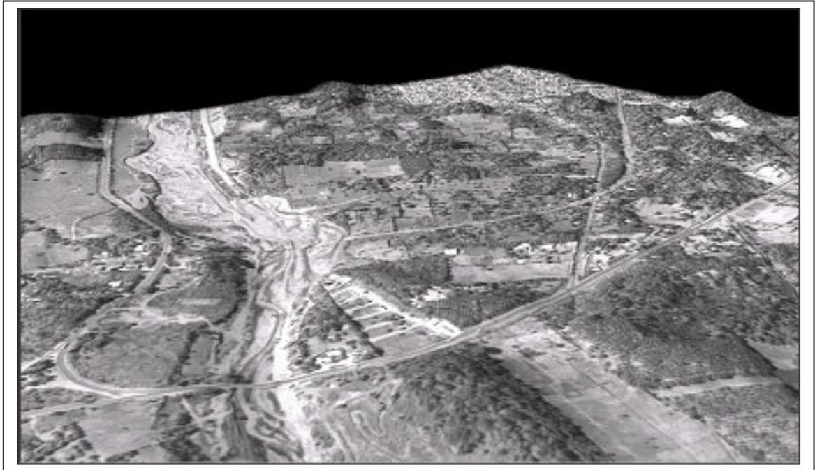
**Modelo 3-D del terreno obtenido a partir de una ortofoto y un Modelo Digital del Terreno (DTM).**
