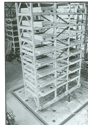
■ Figure 1 Nine-story 1/4-scale Model Test
