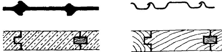
Figura 4.5.-5: Secciones de tablaestacado
